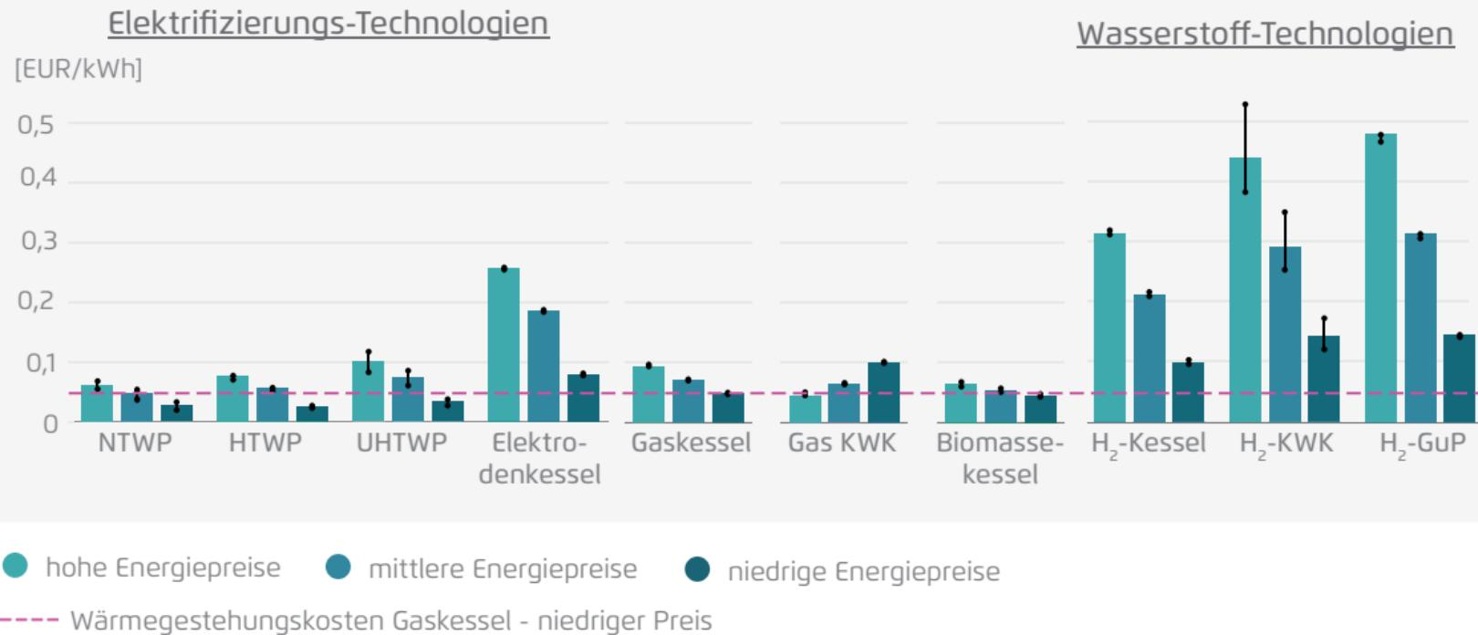
Fraunhofer ISI (2025); NTWP = Niedertemperatur-Wärmepumpe, HTWP = Hochtemperatur-Wärmepumpe, UHTWP = Ultrahochtemperatur-Wärmepumpe, KWK = Kraft-Wärme-Kopplung, GuD = Gas- und Dampfturbinenkraftwerk; Anmerkung: Vergleich der Wärmegestehungskosten (WGK) ohne temporale Klassifizierung der Werte. „heutige Elektrifizierung“ zeigt die verschiedenen Elektrifizierungstechnologien mit aktuellen Preisen („hohe Energiepreise“).
