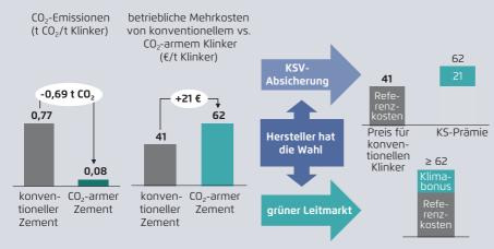
Der Klimanutzen von  $\mathrm{CO_2}$ -armem Klinker wird über den Klimaschutzvertrag vergütet. Zement wird mit der THG-Intensität des konventionellen Klinker-Benchmarks verkauft.
